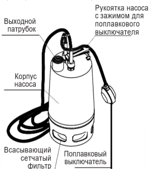
Рисунок 13 – Конструкция насоса WQ QF
